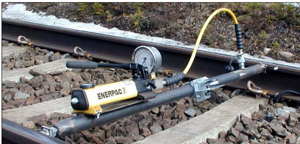
Figur 3. Hydrauliskt pressdon med vilket rälerna belastas lateralt. Därigenom kan befästningens hållkraft bedömas.
