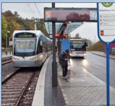
En duospårvagn (TramTrain) är en spårvagn som även kan trafikera det vanliga järnvägsnätet. Den stora vinsten är färre byten för resenärerna. Man kan således åka från den periferin till stadens centrala delar utan byten.
