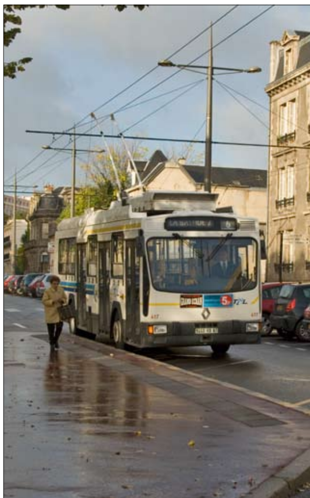
Trådbussens kontaktledning ger linjens dess strukturerande effekt på omgivningen. Genom att utnyttja kontaktledningens bärande stolpar som ett positivt designelement kan kollektivtrafiken ge stadsbilden ett attraktivt tillskott.
