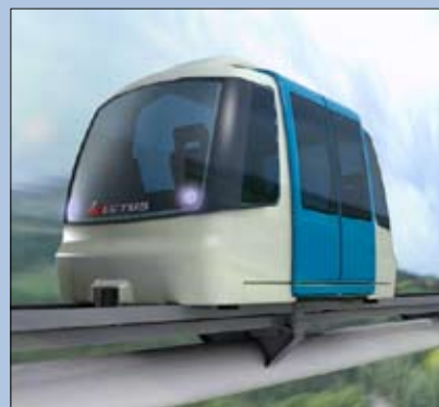
Spårbilar är en del av ett förarlöst lokaltrafiksystem på banor, vanligen ovan mark. Resenärerna åker i eldrivna vagnar (kabiner) i ett finmaskigt bannätverk från påstigningsplats till avstigningsplatsen utan stopp vid mellanliggande hållplatser. Systemet kallas också spårtaxi.
