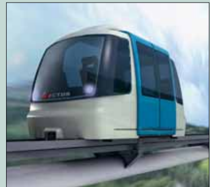
Spårtaxi är en del av ett förarlöst lokaltrafiksystem på banor, vanligen ovan mark. Resenärerna åker i eldrivna vagnar (kabiner) i ett finmaskigt bannätverk från påstigningsplats till avstigningsplats utan stopp vid mellanliggande hållplatser. Systemet kallas också PRT (Personal Rapid Transit).
