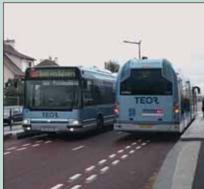
Som en hybridform mellan traditionella bussar och spårvagnar har olika typer av bussar utvecklats som går på egen bana eller i egna körfält med mer eller mindre sofistikerade styrsystem.
