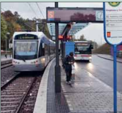
En duospårvagn (TramTrain) är en spårvagn som även kan trafikera det vanliga järnvägsnätet. Den stora vinsten är effektivare resor med färre byten för resenärerna. Man kan således åka från periferin till stadens centrala delar utan byten.
