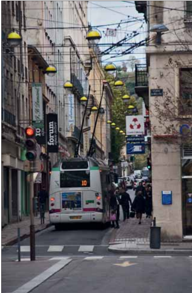
Ovan: Vid smala gator är trådbussen förträfflig tack vare avgasfrihet och låga bullernivåer. Den kommer väl till sin rätt i trånga passager, på gågator, ja, över allt där det är gott om folk tätt intill.
