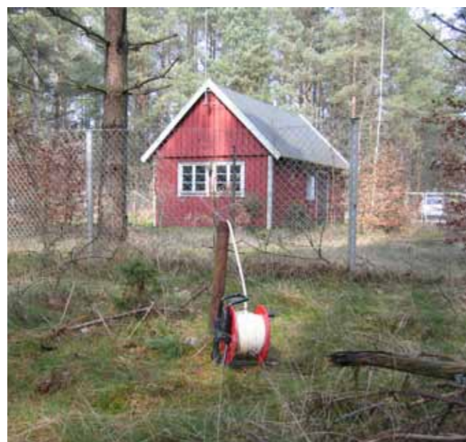
Här pågår pejling av grundvattennivån i ett grundvattenrör.
