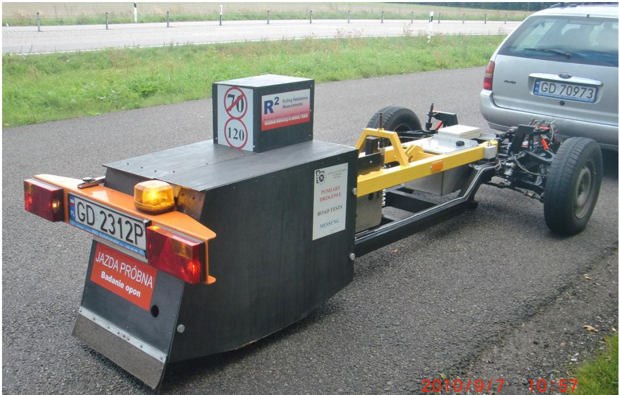
Figur 3. Trailer för mätning av rullmotstånd från TUG, som använts i detta projekt. Foto från TUG.
