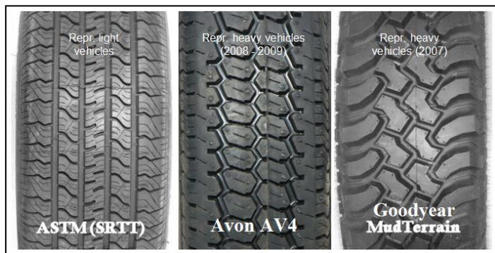
Figur 2. De tre referensdäck som har använts, från vänster SRTT, AAV4 och GYMT. Se vidare texten.
