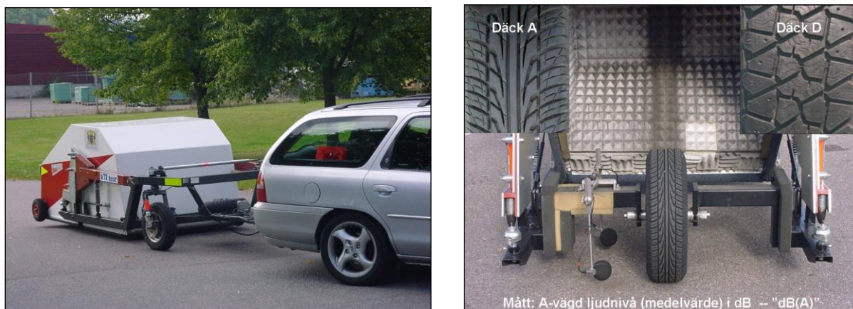
Figur 1. Mätvagn för bullermätning i stängt läge (mätning) och i öppet läge.
