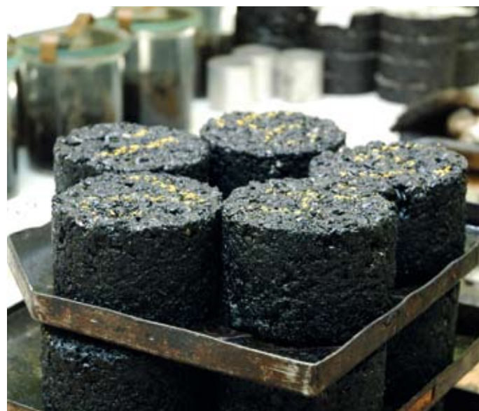
Så kallade "provkroppar" av gummi-asfalt används för att studera dess egenskaper.
