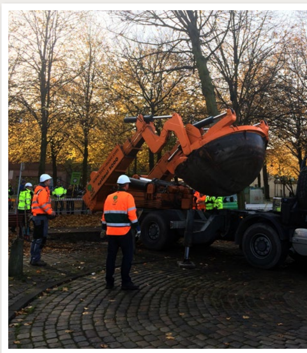
Träden flyttas med hjälp av trädflyttningsmaskiner, tre kommer från Tyskland. Varje maskin har olika stor kapacitet att lyfta olika stora träd. FOTO: VÄSTLÄNKEN
