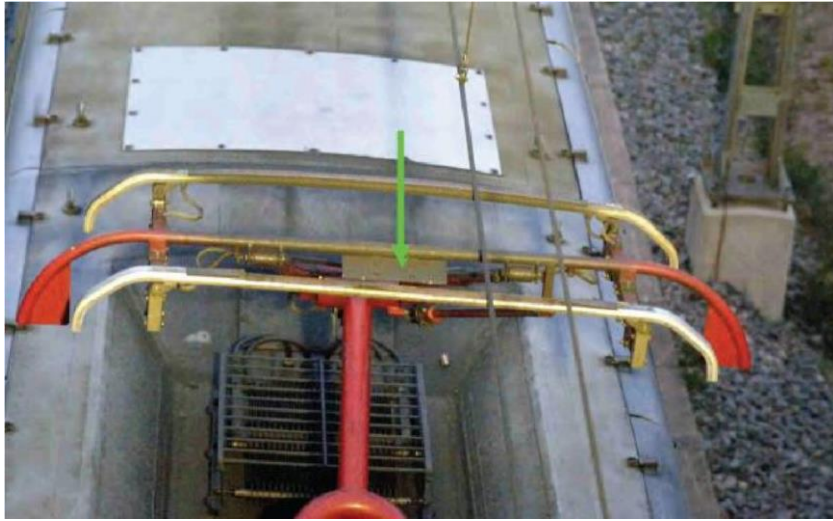
Figur 7: Exempel på bild från kolslitskenedetektor
