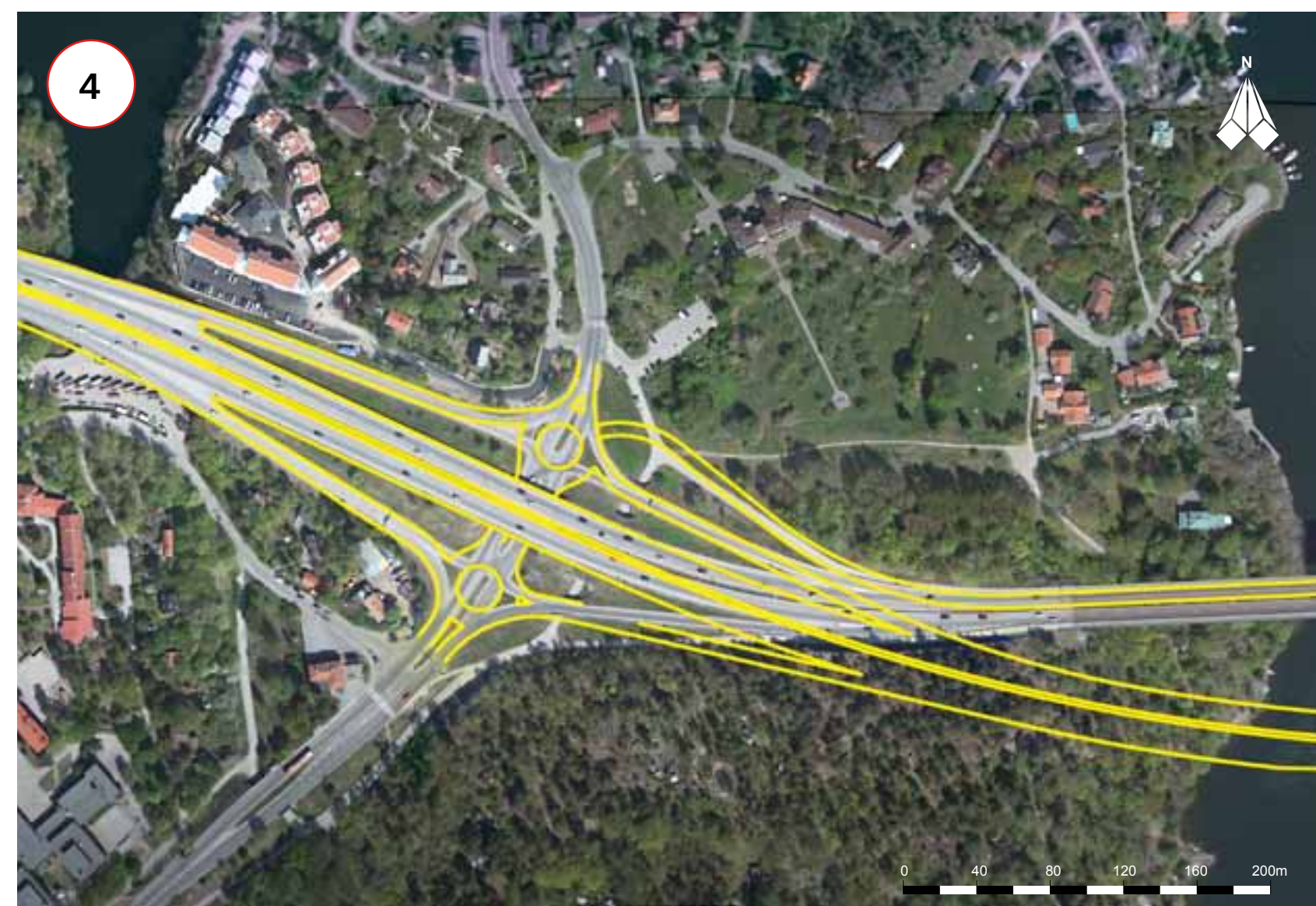
Trafikplats Skuru Hel. Fullständig trafikplats i Skuru med ramper mot Stockholm och Värmdö.
