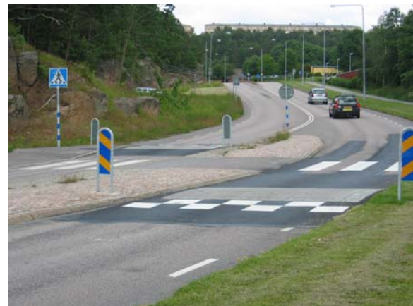
Diagram 27 och 28. Gupp placerat framför övergångsstället i båda körriktningar. Bred refug har kompletterat övergångsstället.
