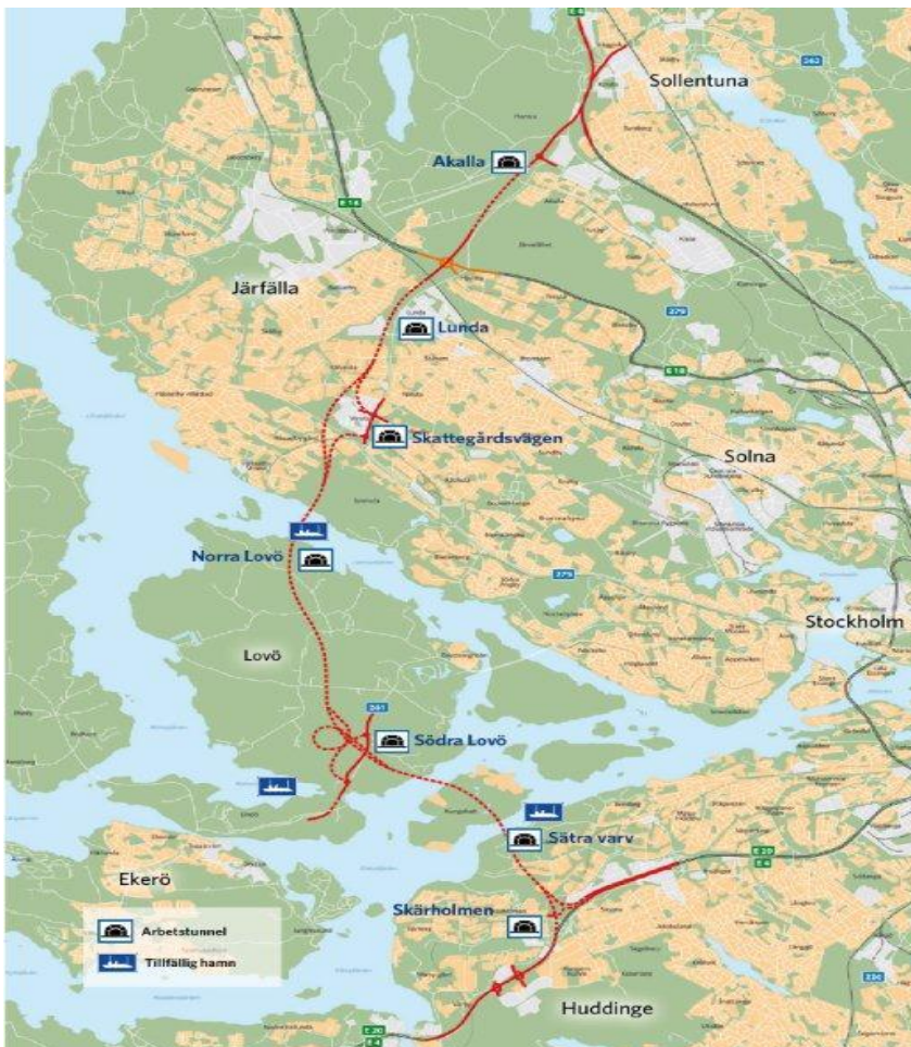
Figur 1. Förfart Stockholm är en ny sträckning av E4 väster om Stockholm. Under byggtiden byggs tre tillfälliga hamnar för att kunna skeppa byggmassor på vatten.
