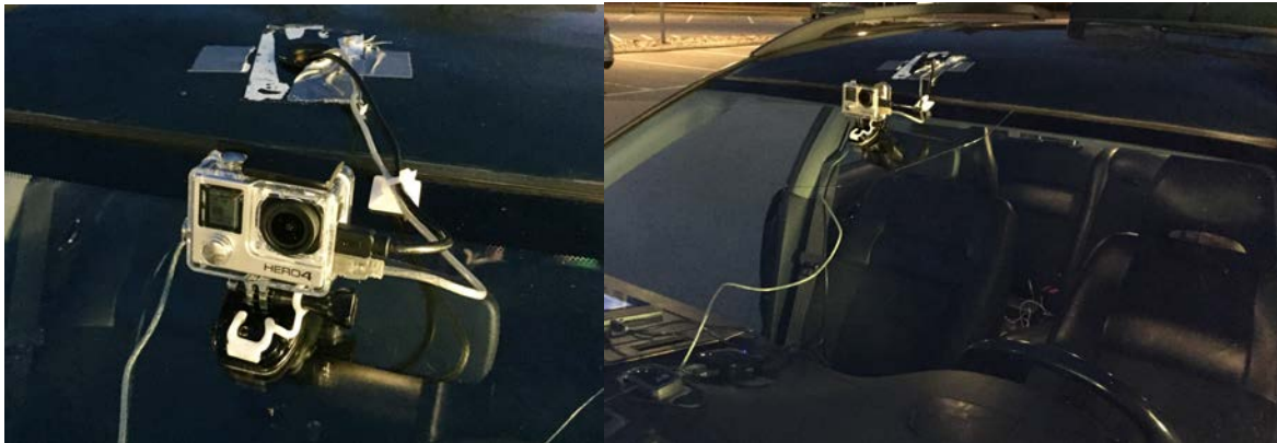
Figur 3.5 Videokamerans placering på inspelningsbilen.
