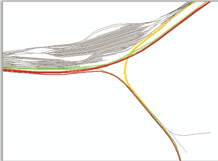
Figur 2 Exempel på symbolik baserad på 2 attributkolumner och samtidigt urval. Symbolik: Spår Huvud/Sido/IndKod och Spår Upp/Ned/Enkel/IndKod. Urval: Elektrifierade spår.
