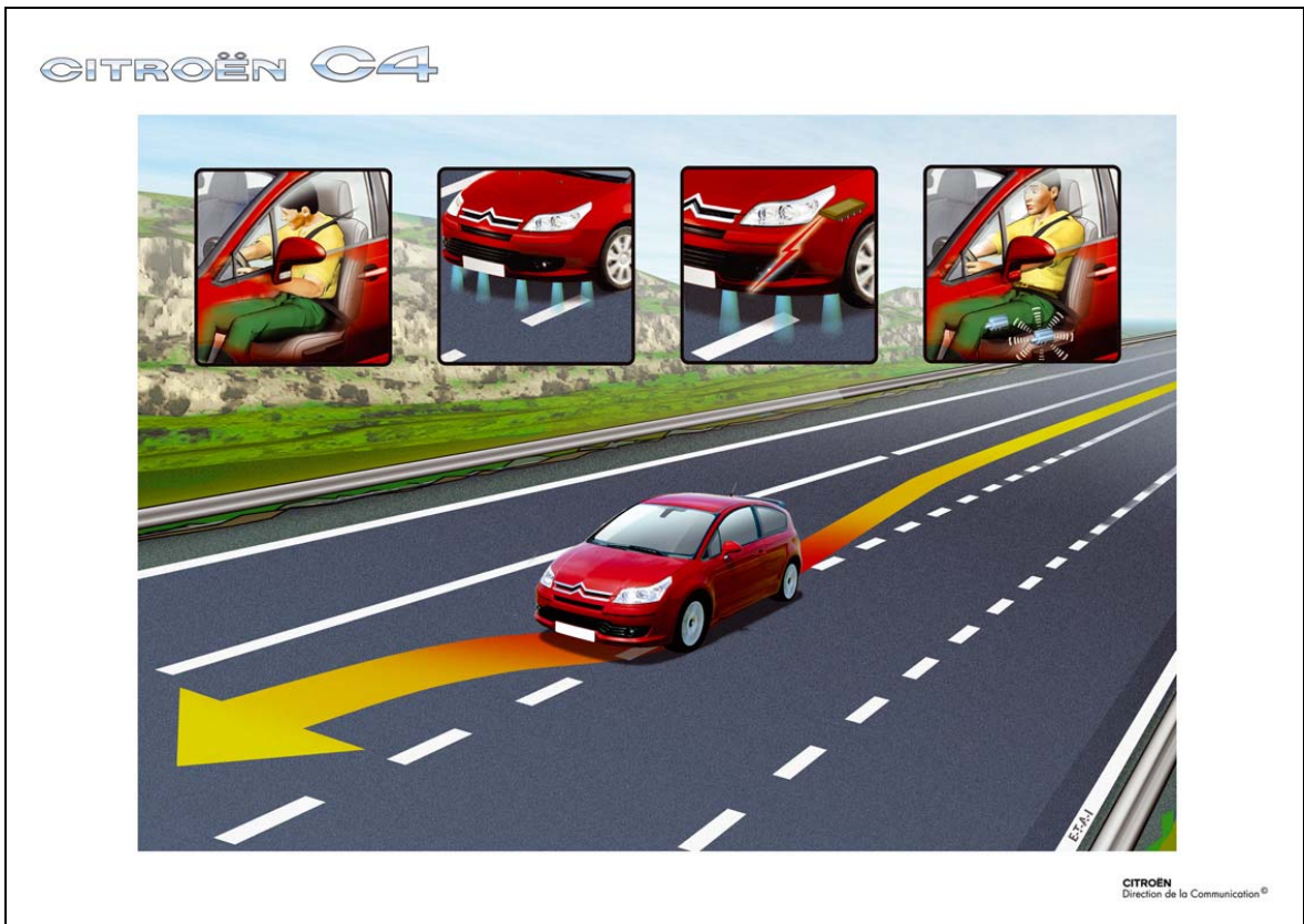
Figur 1 AFIL-varning vid ofrivillig överträdelse av kantlinjen (med tillstånd av Citroën).
