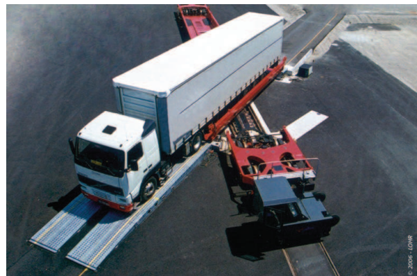
Hur trailers hanteras med Modalohr (källa: www.modalohr.com)
