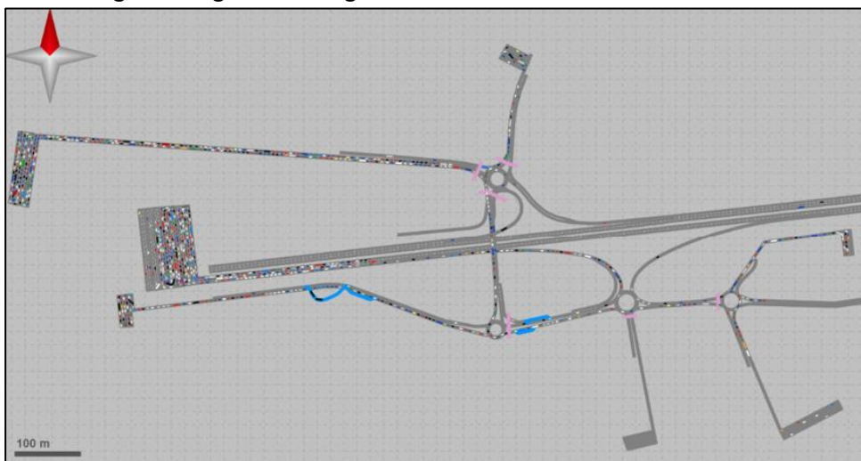
Figur 2.1.3:2. Ögonblicksbild. Köbildning för eftermiddagstrafik år 2040 och befintlig utformning. Långa köer uppstår från de flesta håll. Källa: PM Trafikutredning E20 Partille – Partillemotet och Skultorpsmotet, 2024, WSP
