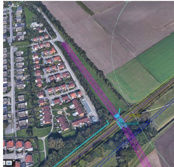
Lila sträckning visar Gränsvägens förlängning över spåren
