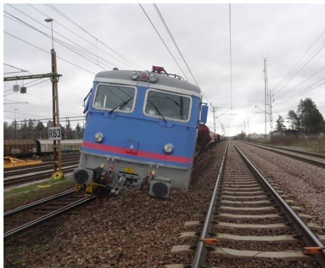
Urspårat tåg nära intilliggande spår.
