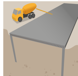
4. Ett armerat tunnelvalv gjuts i etapper direkt på marken mellan de färdiga tunnelväggarna.
