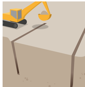
1. Vertikala slitsar schaktas i marken. Slitsarna stabiliseras med en vatten- och bentonitblandning, en slags lervälling.
