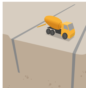
3. Stödmuren gjuts. Betongen pumpas ner i slitsarna samtidigt som bentoniten pumpas tillbaka till blandningsstationen.
