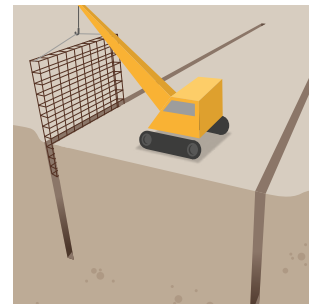
2. Armering sänks ner i slitsarna.
