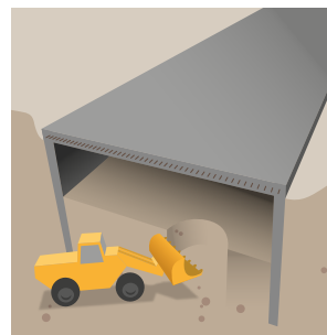
5. När valvet är klart kan massorna schaktas ut successivt ner till nivån där spåren ska byggas.
