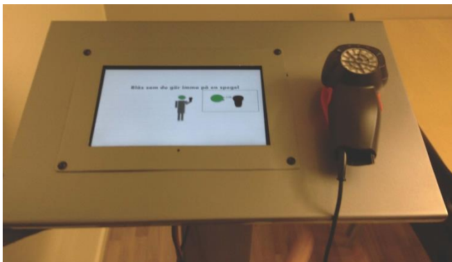
Figur 3. En första modulprototyp med handhållen alkomätare
