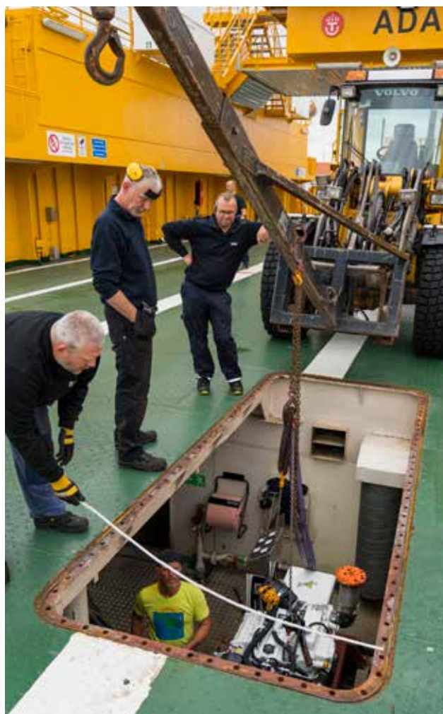
Hönöleden minskade sina utsläpp med 90 procent tack vare att färjornas ena dieselgenerator byttes ut och att ett miljövänligt bränsle tillsammans med en katalysator används.
