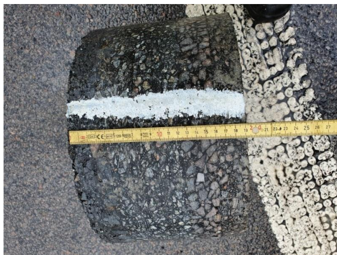
Figur 5: Borkärna med vit lösningsmedelsbaserad sprayfärg. Källa: Sven Agardh, Ramböll.
