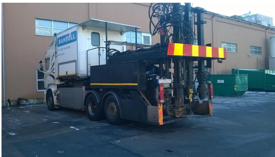
Figur 4: Lastbil med borrhutrustning monterad. Källa: Sven Agardh, Ramböll.
